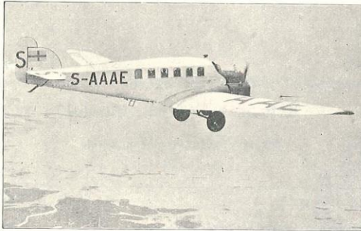
En Junker Maskine — G 24 — til 9 Passagerer tilhørende A.-B. Aerotransport.
